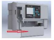
Unterbrechen Sie die Stromversorgung der Batterie Backup Versorgung und setzen die Abdeckung wieder ein.
