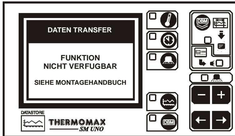
Um Daten zur Masterlink Hardware herunterzuladen oder direkt von einem Thermomax Drucker drucken zu können, muß das Netzwerk ausgeschaltet werden.
